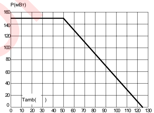
Рис. 4 Снижение рассеиваемой мощности от температуры окружающей среды (максимальные значения)
